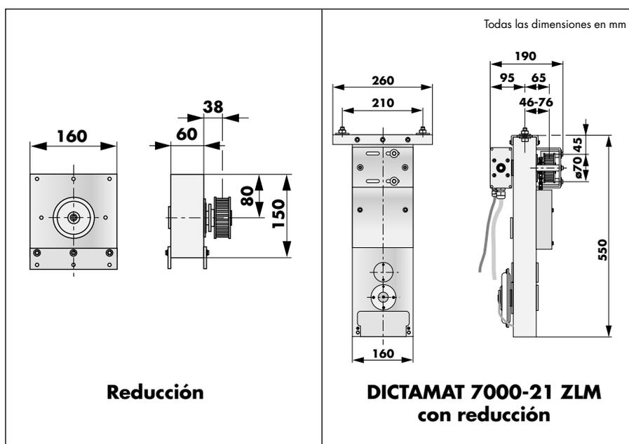
La reducción DICTATOR se fija por encima del módulo principal del accionamiento mediante dos placas de montaje. Se desmonta la polea motriz del accionamiento y en su lugar se pone el piñón pequeño. Una cadena une ambos piñones (él del accionamiento y él de la reducción). Al final se monta la tapa de aluminio.
