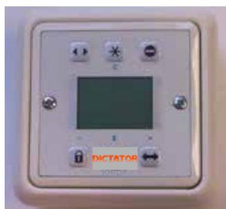
Con el módulo de servicio BDE-D se pueden adaptar los ajustes de fábrica y programar funciones adicionales. Las opciones y parámetros siguientes se pueden realizar en obra con un **BDE-D portátil**:
